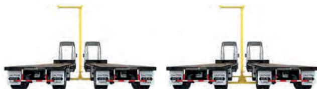
La base estabilizadora se puede girar 90°
